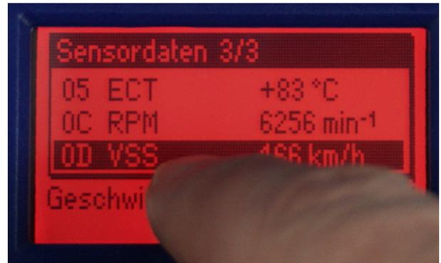
punkt und unter welchen Bedingungen (Umgebung) der Fehler zu ersten Mal aufgetreten ist. Zu jedem Fehler können eine ganze Reihe solcher Variablen gespeichert sein. Mit den Tasten 1 und 2 kann man diese „Freeze-Frames“ für den jeweiligen Fehler durchscrollen.
