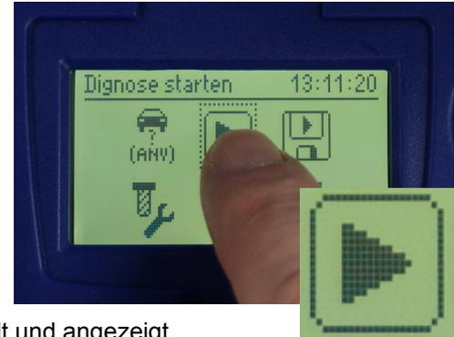
5. Bei erfolgreichem Connect ist das Diagnose Menü sichtbar. Fehlerspeicher, die Fehlerumgebung (Freeze-Frames) und Fahrgestellnummer
